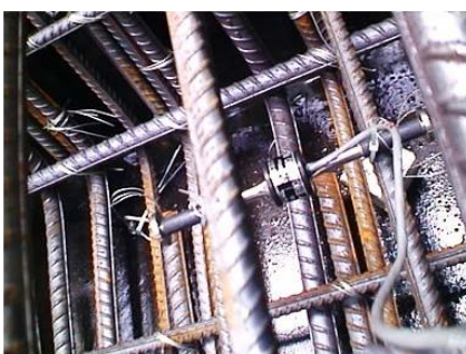
Extensómetro de cuerda vibrante EDS-20V-E embebido en hormigón
