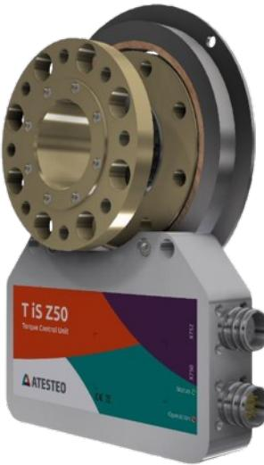
Su estructura de brida hueca optimizada y su capacidad de soportar cargas parásitas (fuerzas axiales y momentos flectores) sin comprometer la pureza del par torsor, lo definen como el instrumento de referencia para la validación de motores eléctricos y sistemas de propulsión avanzada. El SiS Z50 es la elección definitiva cuando se requiere la máxima inteligencia integrada junto con la precisión de un sensor de laboratorio.
