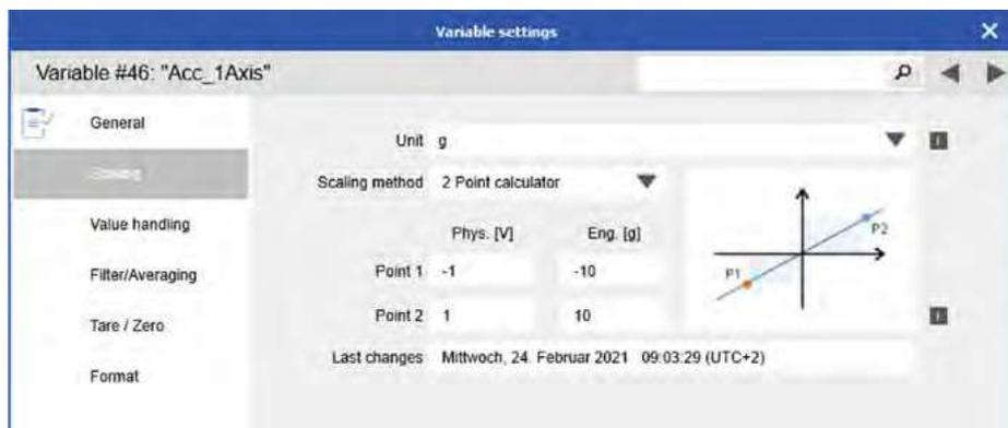
Abbildung 4: Skalierung Sensor in Gi.bench
