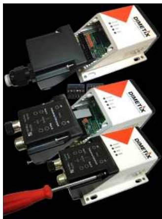
Sistema de Cubierta Modulable y Escalable
